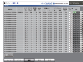
レーザ出力 / 加圧力 / 沈み込み量リアルタイムモニタリング
